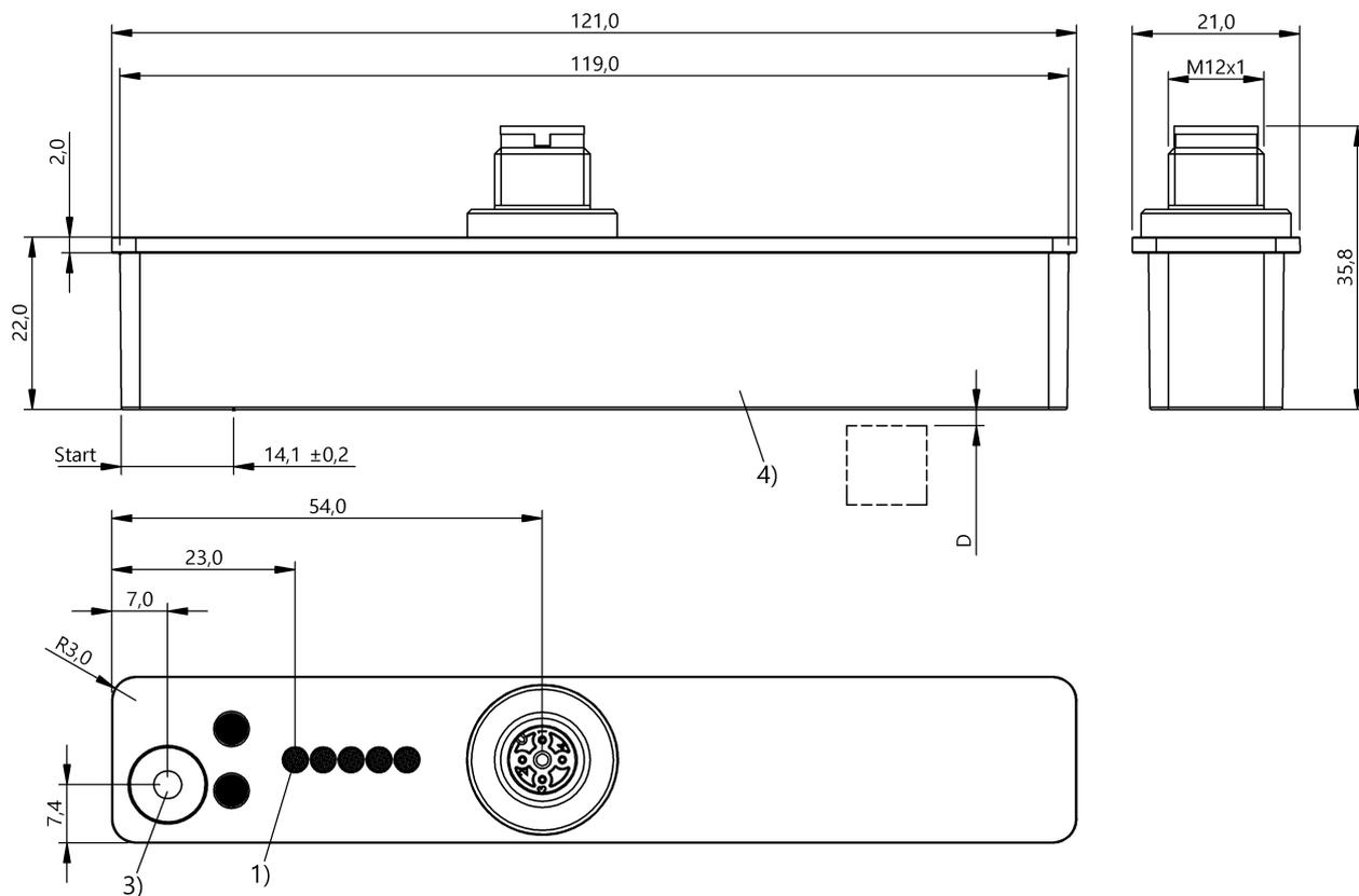
1) Функциональный СД, 3) Кнопка запоминания, 4) Датчик положения
